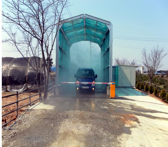
터널식 차량 소독기로서 필히 대인 소독을 한 후(1단계 차단기 열림) 차량에 탑승하여 차량을 터널내에 정차 시킨 후 차량 소독을 충분히 한 후 2단계 차단기가 열린 후 농장으로 진입하는 확실한 완전방역 시스템임, (운전석 소독은 농가에 비치한 소독약으로 방역함)
